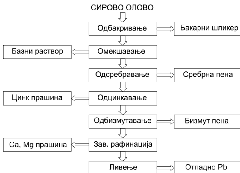
Слика 4. Настанак међупродуката при процесу рафинације сировог олова
