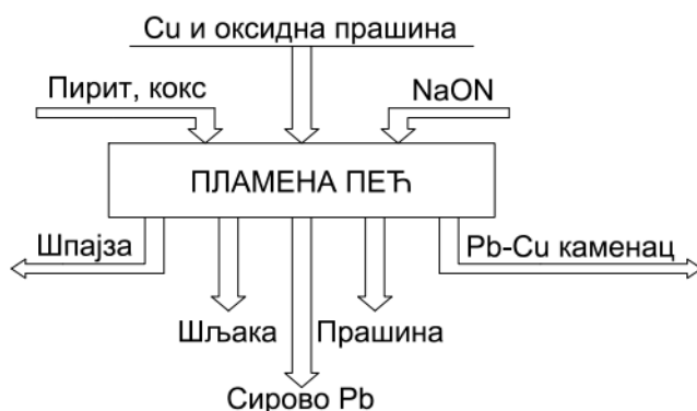
Слика 15. Шема прераде бакарног шликера и оксидне прашине у пламеној пећи
