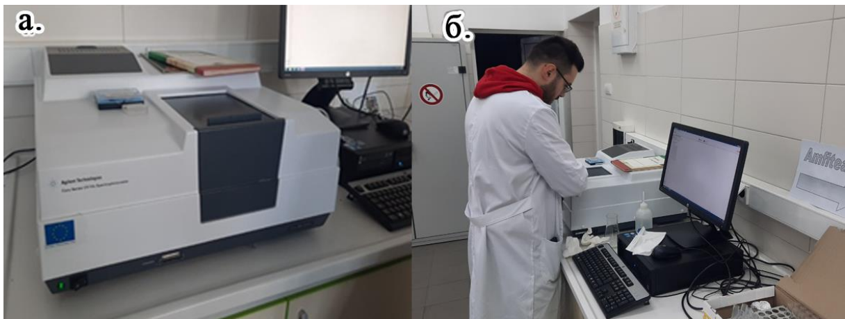
Слика 10. Спектрофотометријска мерења: Спектрофотометар Cary Series 300 Agilent Technologies (а); Изглед радног простора (б) (оригинал, Д. Грчак)
