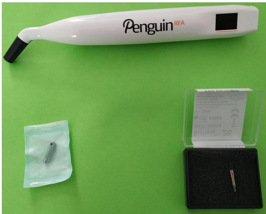
Слика 25. Пингвин апарат (Penguin RFA), Smart рег и преносник
