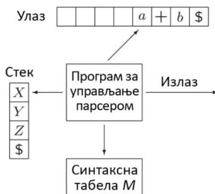
Слика 20. Предиктивни парсер заснован на синтаксној табели
