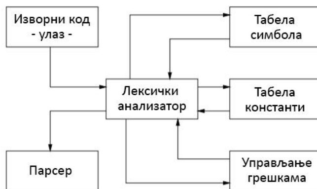
Слика 4. Процес лексичке анализе
