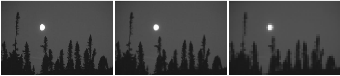
Слика 4.18 - Пример слике са малим бројем детаља где је примењена haar wavelet трансформација за три нивоа декомпозиције.
