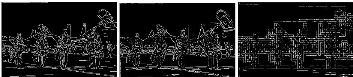
Слика 4.22 - Пример слике са средњим бројем детаља где је примењен Canny оператор за детекцију ивица за три нивоа декомпозиције haar wavelet .
