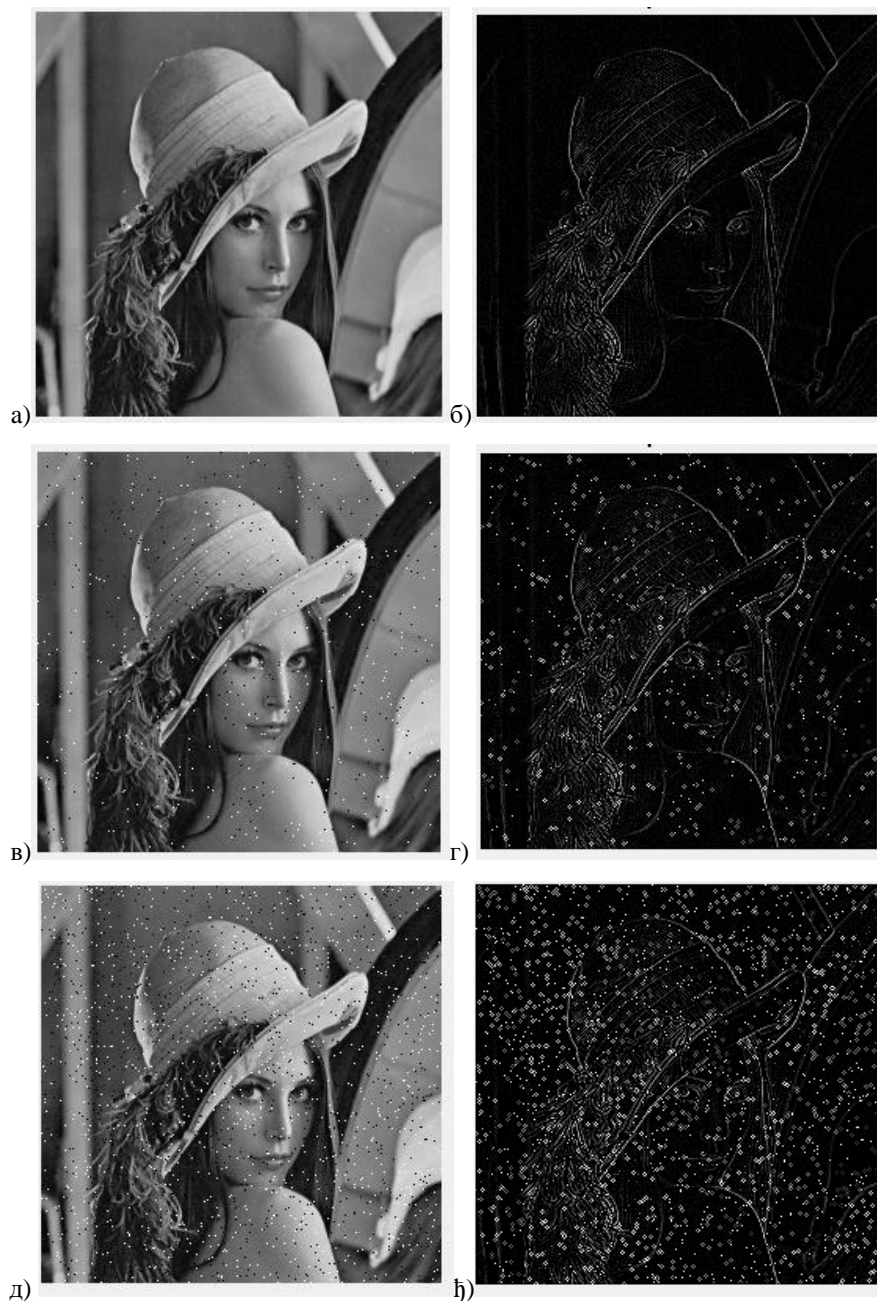
Слика 2.8 - Детекција ивица помоћу Лапласовог оператора: а) оригинална слика, б) детекција над оригиналном сликом, в) оригинална слика са присуством мање количине шума, г) детекција ивица у присуству мање количине шума, д) оригинална слика са већим присуством шума, њ) детекција ивица у присуству веће количине шума.
