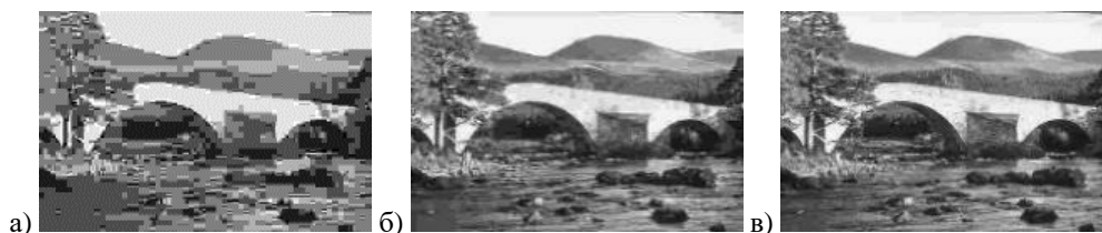
Слика 4.8 - MD слике компресоване SPIHT алгоритмом при BPP : а) 0.1, б) 0.3, в) 0.5, г) 1, д) 1.5, њ) 3.
