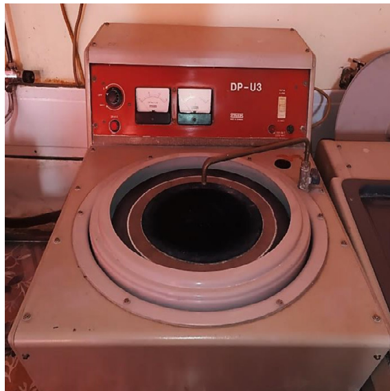
Слика 9. Уређај за полирање узорака, модел DP-U3, фирме Struers.
