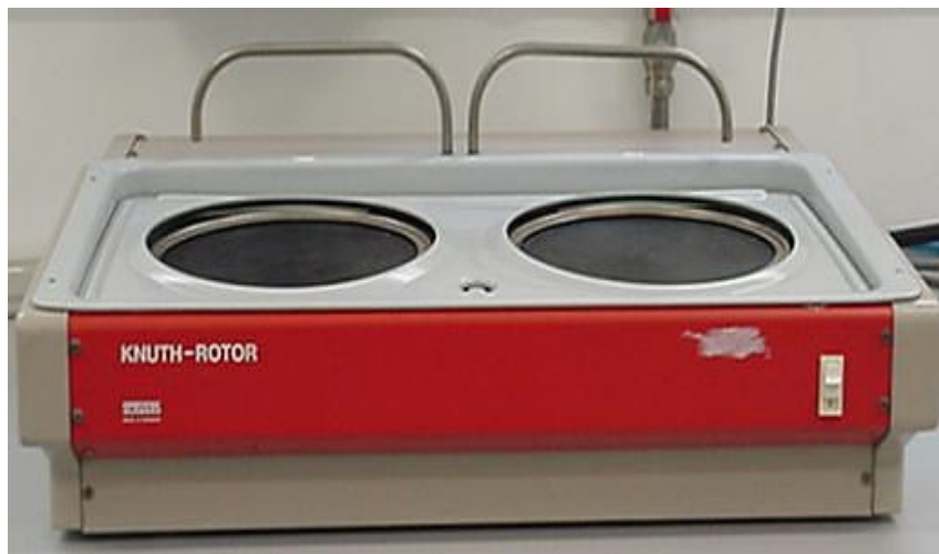
Слика 8. Уређај за брушење узорака, модел KNUTH ROTOR, фирме Struers.
