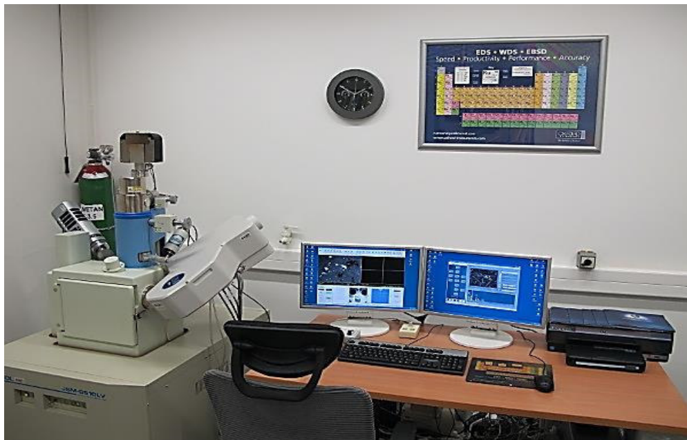
Слика 10. Скенирајући електронски микроскоп, модел JEOL JSM-6460.
