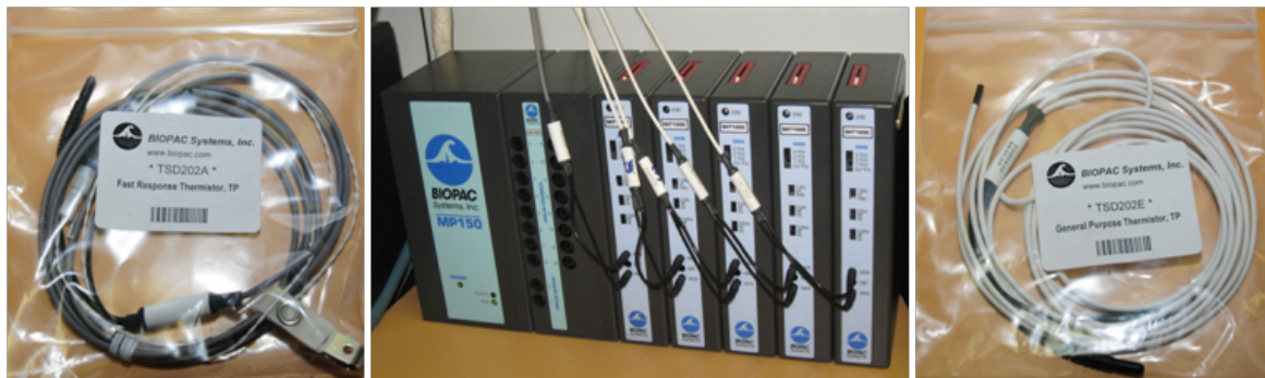
Слика 13. Мерно-аквизициони систем MP150 Биорас: Мерна јединица MP150/100, универзални модул UIM100C и диференцијални модули SKT 100C; термо-сензор TSD202A; термо-сензор TSD202E.
